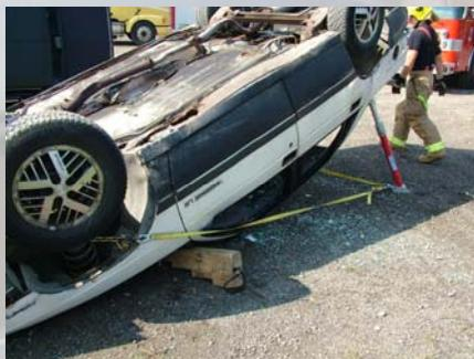
La stabilisation avec un tel système permet de maintenir le véhicule et même de le soulever au besoin. Les vérins du RESQ-JACK sont assez puissants pour soulever un tableau de bord d'un véhicule (Dash over).
